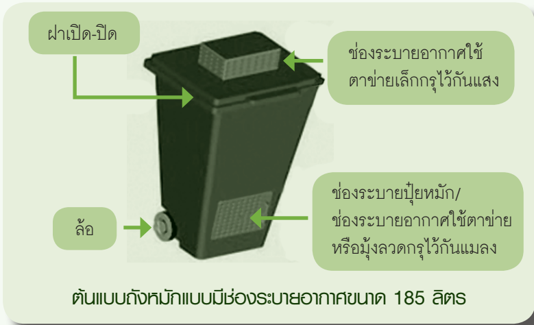
รูปที่ 4.9 ถังหมักมูลฝอยอินทรีย์แบบมีช่องระบาย อากาศขนาด 185 ลิตร
